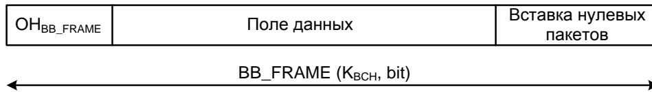
Рис. 3. Структура кадра основной полосы BB\_FRAME
