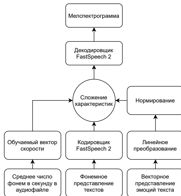
Рис. 10. Модификация архитектуры FastSpeech 2 для синтеза эмоциональной речи
