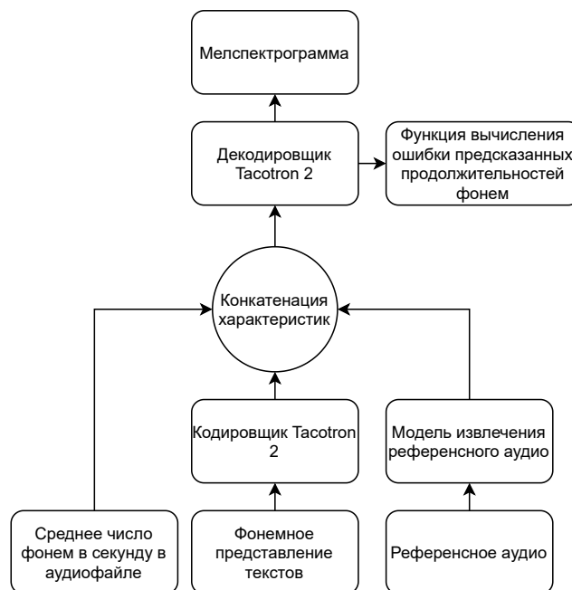
Рис. 5. Модификация архитектуры Tacotron 2, учитывающая скорость произношения, глобальный токен стиля и дистиллирующая знания о продолжительностях фонем
