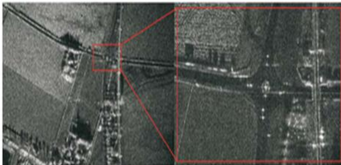
Рис. 4. РЛИ с разрешением 1 м и спутниковый фотоснимок одной и той же местности
