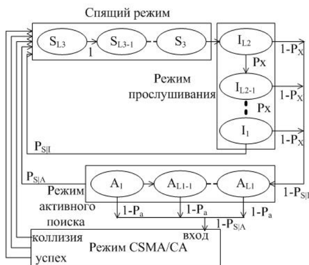
Рис. 2. Функциональная модель узлов ретрансляции
