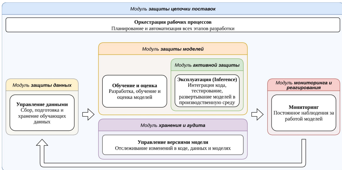
Рис. 2 Связь модулей подсистемы ИБ и основных этапов жизненного цикла MLOps
