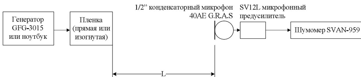
Рис. 2. Структурная схема измерительной установки для определения АЧХ
