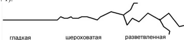
Рис. 1. Модель траектории развития трещины
