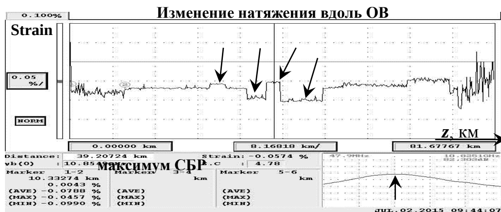
Рис. 9. Картина распределения натяжения (strain) вдоль ОВ, соответствующая 3D-рефлектограмме, представленной на рис. 8.
