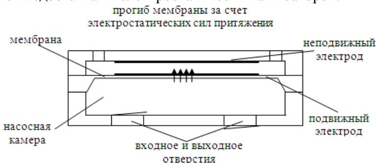
Рис. 3. Схематическое изображение электростатического микронасоса
