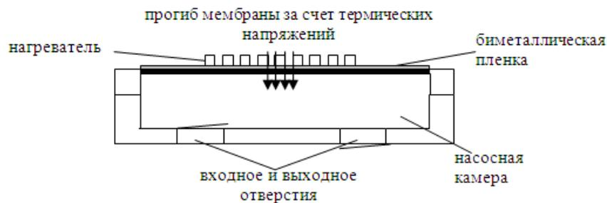
Рис. 6. Схематическое изображение биметаллического микронасоса
