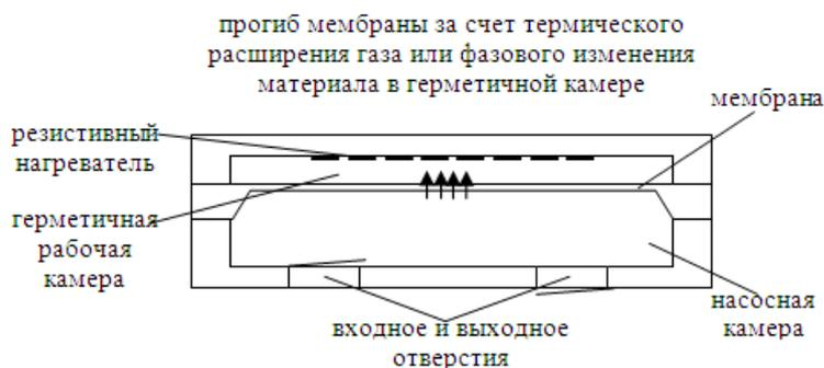
Рис. 4. Схематическое изображение термопневматического микронасоса
