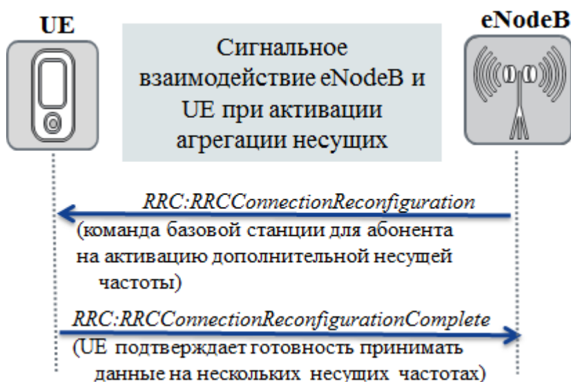
Рис. 2. Сигнальное взаимодействие между базовой станцией eNodeB и абонентом UE в LTE-Advanced с поддержкой Carrier Aggregation для активации дополнительной несущей частоты
