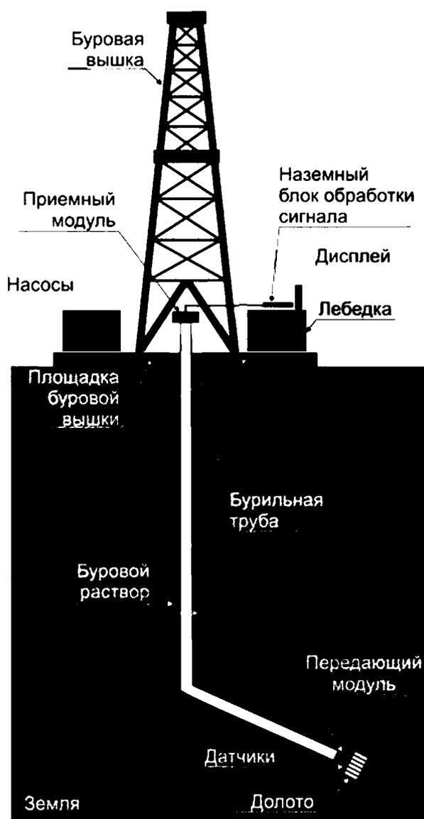
Рис. 1. Структура забойной телеметрической системы
