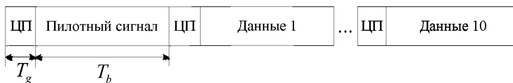
Рис. 4. Структура кадра, используемая для моделирования
