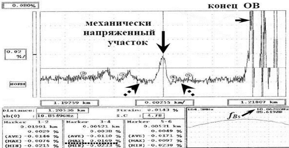
Рис. 6. График натяжения при растягивающем воздействии на участок ОВ
