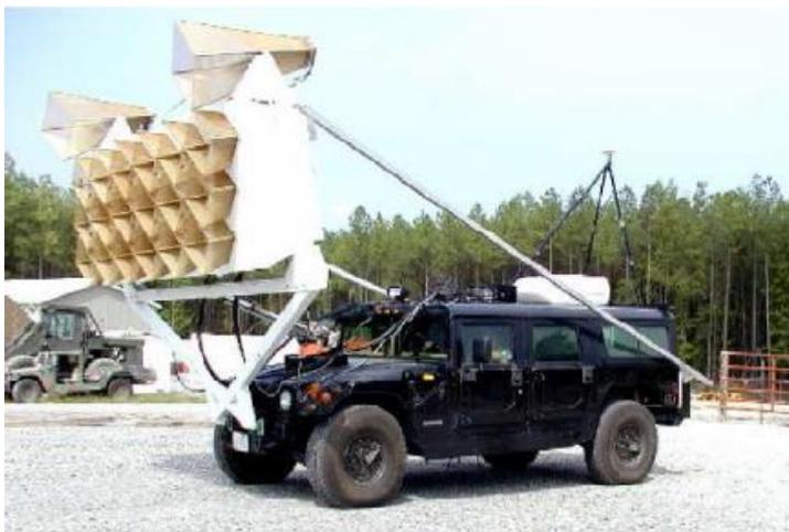
Рис. 7. Радиолокационная система FLGPR SRI
