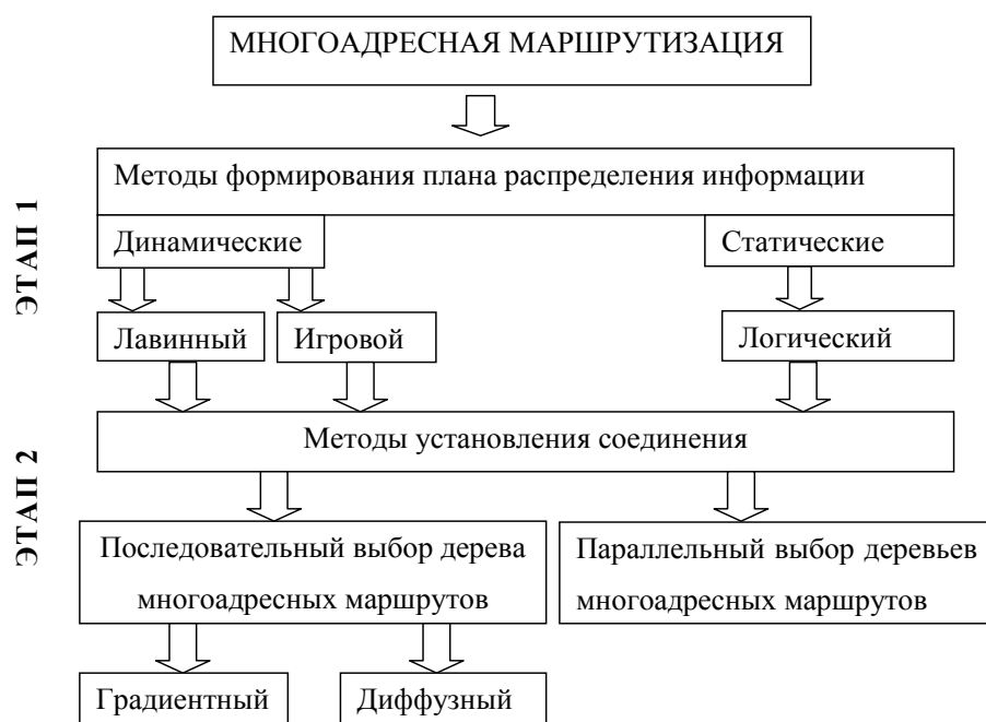
Рис. 1. Классификация методов многоадресной маршрутизации
