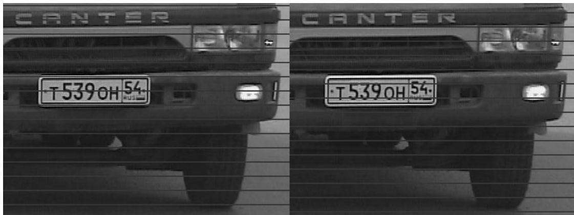
Рис. 1. Сканирование изображения с шагом в половину высоты номерного знака
