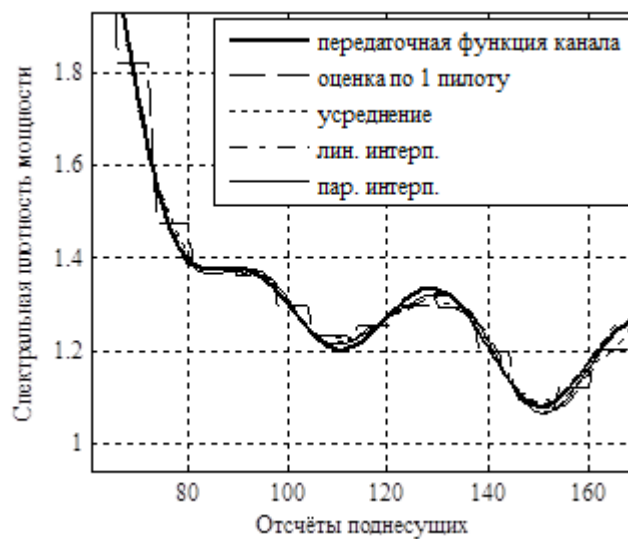
Рис. 2 Пример оценки передаточной функции канала различными методами
