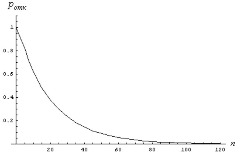
Рис. 1. Зависимость вероятности сохранения максимальной производительности от размера структурной избыточности:  $\mu = 0.1 \text{ ч}^{-1}$ ;  $\lambda = 10^{-4} \text{ ч}^{-1}$ ,  $N = 2 \cdot 10^4 \text{ ЭМ}$
