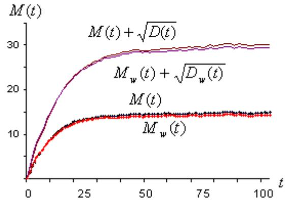
Рис. 5. Зависимость среднего числа отказавших ЭМ находящихся в ВУ от времени. Расчёт выполнен согласно имитационной модели
