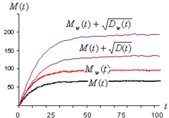
Рис. 7. Зависимость среднего числа отказавших ЭМ, находящихся в ВУ, от времени. Расчёт выполнен согласно имитационной модели.  $N = 7.5 \cdot 10^4, \lambda = 10^{-4} \text{ 1/ч}, \mu = 0.1 \text{ 1/ч}$
