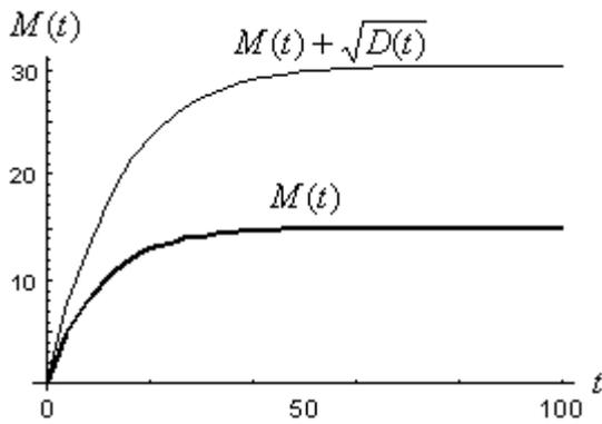
Рис. 4. Зависимость среднего числа отказавших ЭМ, находящихся в ВУ, от времени. Расчёт выполнен согласно формулам (7). Рассматриваются простейшие потоки
