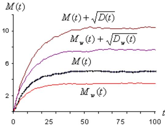
Рис. 6. Зависимость среднего числа отказавших ЭМ, находящихся в ВУ, от времени. Расчёт выполнен согласно имитационной модели.  $N = 5 \cdot 10^3, \lambda = 10^{-4} \text{ 1/ч}, \mu = 0.1 \text{ 1/ч}$
