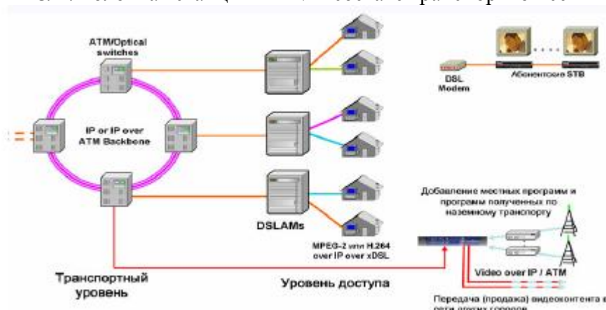
Рис. 1. Головная станция IP TV в составе транспортной сети
