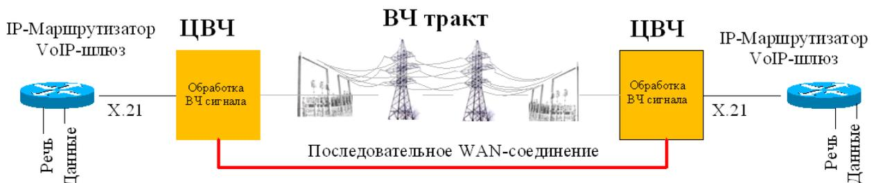
Рис. 2. Схема IP-ВЧ-канала с использованием последовательного WAN-соединения
