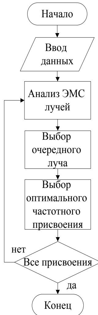
Рис. 2. Частотное планирование сети СПСС с использованием алгоритмов вершина-краска и краска-вершина
