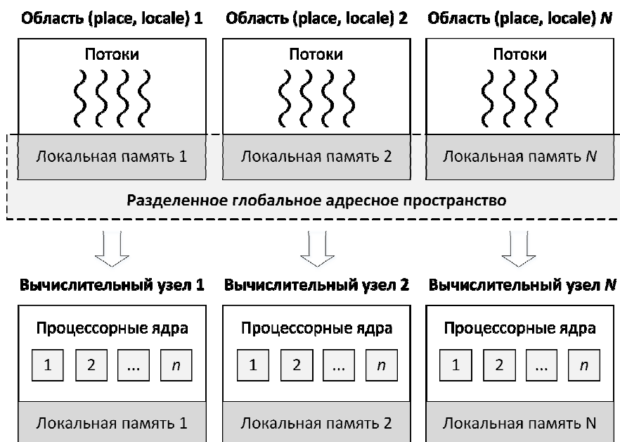
Рис. 1. Модель разделённого глобального адресного пространства (PGAS)
