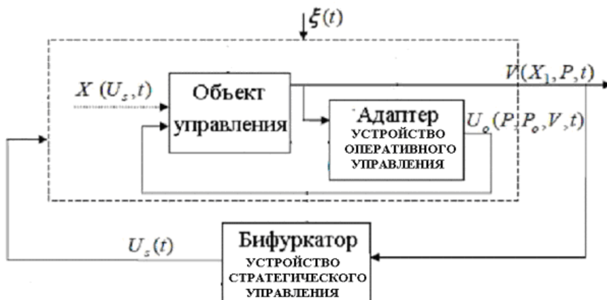
Рис.1. Двухконтурная система управления сложным объектом
