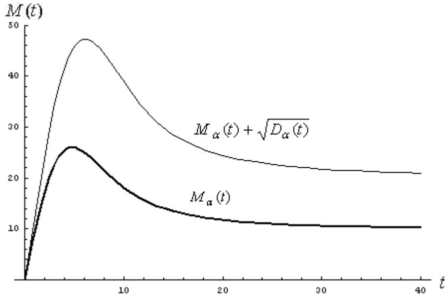
Рис. 1. Зависимость средней наполненности накопителя задачами от времени  $t$  с учётом дисперсии при  $\alpha = 10$  1/ч,  $\beta = 1$  1/ч,  $\psi(N(t)) = N(t)$ ,  $\lambda = 10^{-4}$  1/ч,  $N = 2 \cdot 10^4$ ,  $\mu = 0.1$  1/ч,  $j = 200$
