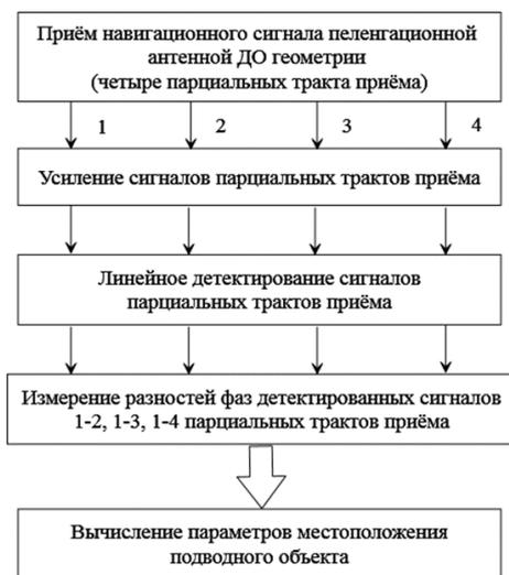
Рис. 2. Функциональные операции при позиционировании подводного объекта с линейным детектированием навигационного сигнала
