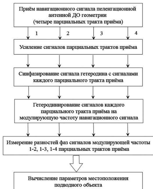
Рис. 3. Функциональные операции при позиционировании подводного объекта с синхронным гетеродинированием навигационного сигнала
