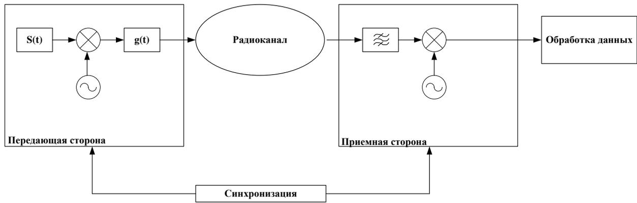
Рис. 2. Общий принцип зондирования канала
