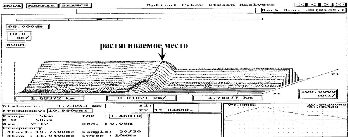
Рис 5. Картина СБР в световоде при продольной нагрузке 5 Н (500 г)
