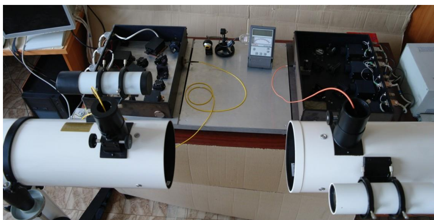
Рис. 1. Внешний вид модернизированной экспериментальной установки для генерации квантового ключа в атмосферном квантовом канале с добавленными телескопами для расширения лучей.
