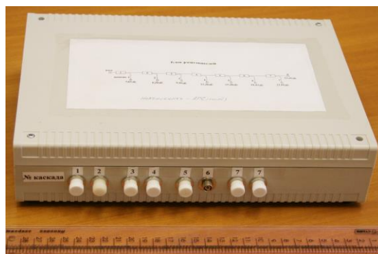
Рис.15. Макетный образец оптического разветвителя на 128 каналов (выход на 2 канала)
