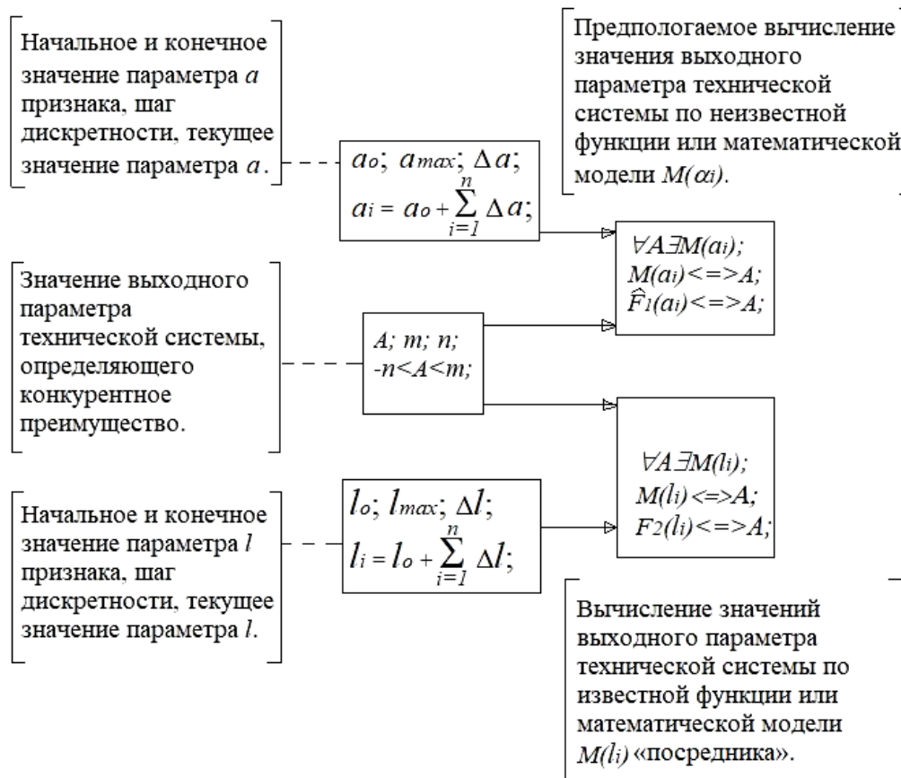
Рис. 3. Пример преобразования семантической матрицы признаков в конечные упорядоченные множества аргументов известной и неизвестной функций
