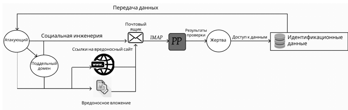
Рис. 4. Модель взаимодействия участников фишинговой атаки с интегрированной системой защиты
