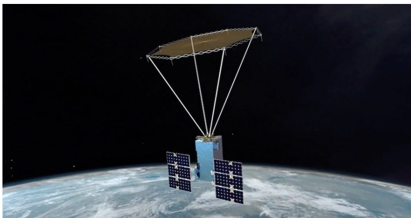
Рис. 2. 3D-модель спутника с развернутой отражательной антенной решеткой на основе пленки из полиимида
