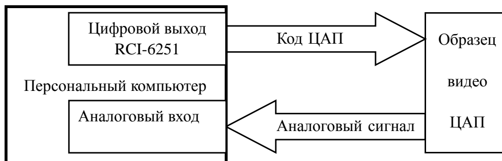
Рис.1. Блок-схема проведения измерений параметров чипа видеodeкодера
