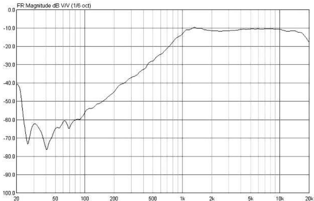
Рис. 6. АЧХ купольной ВЧ-головки Т26.8 со сглаживанием 1/6 октавы при уровне звукового давления 90 дБ/м [6]
