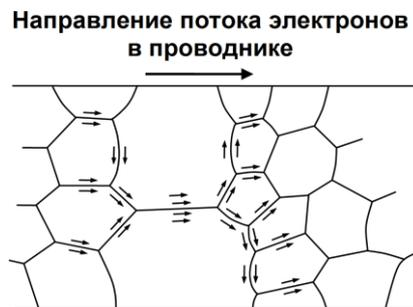
Рис. 1. Демонстрация локального повышения плотности тока в металлическом проводнике
