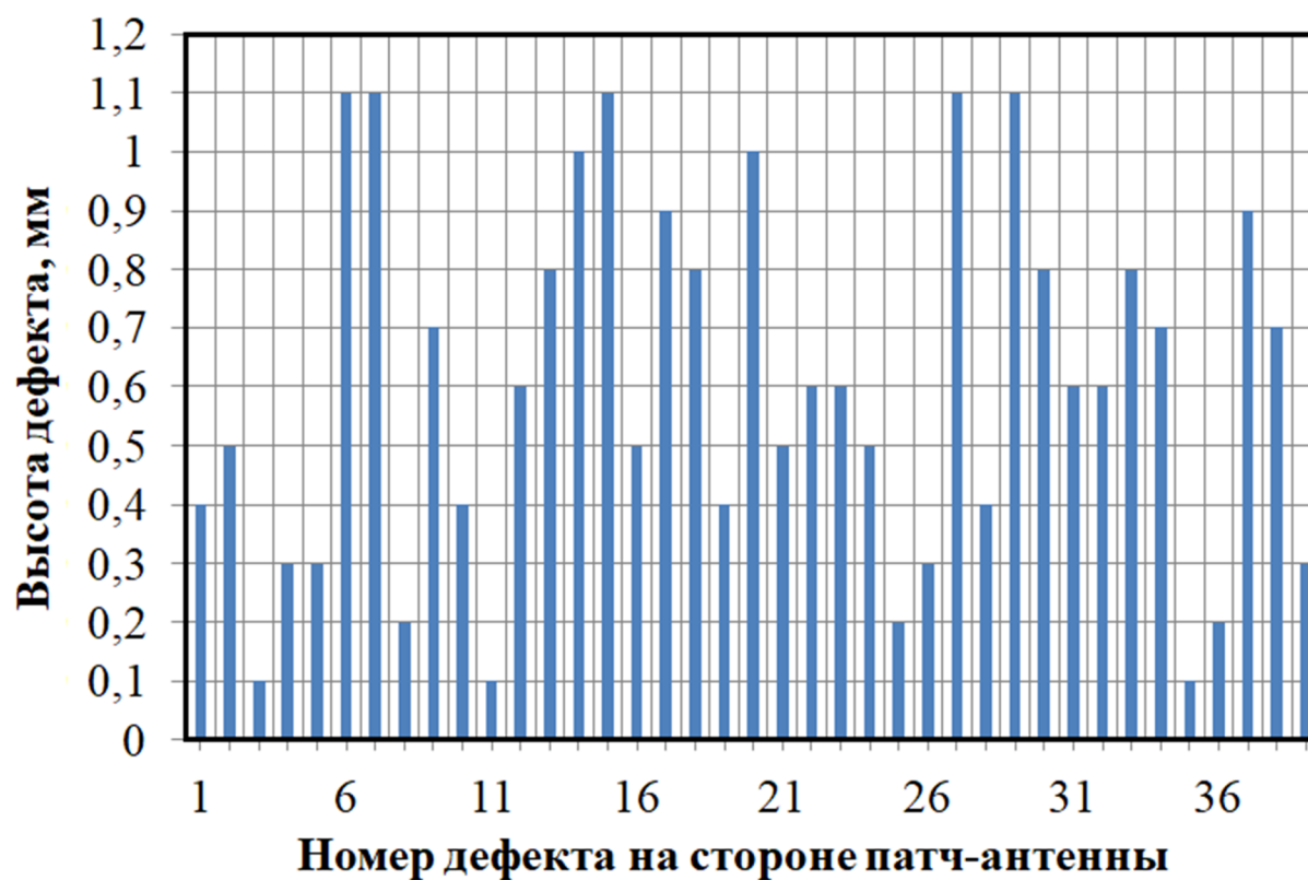
Рис. 12. Распределение дефектов на стороне патч-антенны
