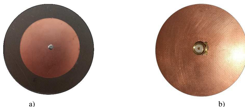
Рис. 3. Круглая патч-антенна: а) излучающая сторона антенны, б) отражающая сторона антенны
