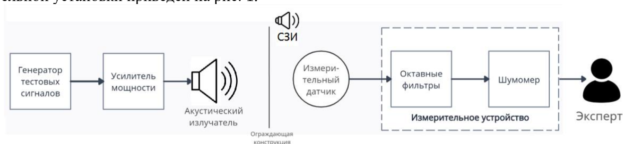
Рис. 1. Состав измерительной установки при оценке защищенности акустической речевой информации в помещении
