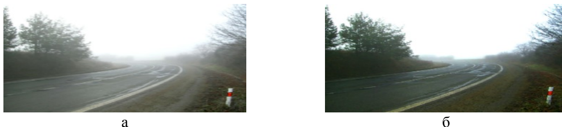
Рис. 1. Применение автоматического удаления статичных погодных явлений а – исходное изображение; б – обработанное изображение
