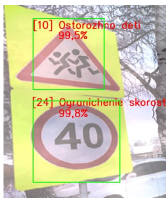
Рис. 6. Результаты распознавания дорожных знаков при угловой съемке ( 20^\circ )
