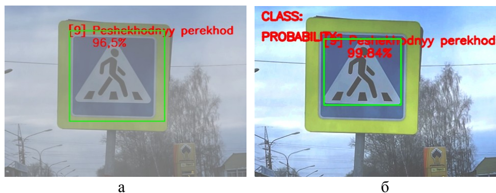
Рис. 5. Результаты распознавания дорожных знаков при прямой съемке ( 0^\circ )
