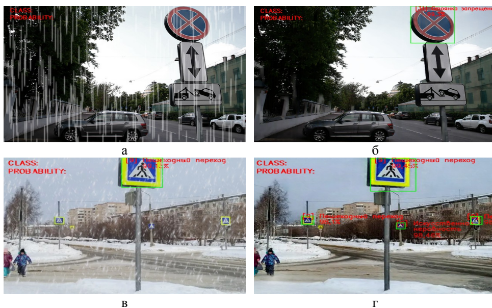
Рис. 5. Пример работы алгоритма удаления изображений дождя и снега при повороте знака в плоскости на 30^\circ : исходное изображение – а, в; обработанное изображение – б, г
