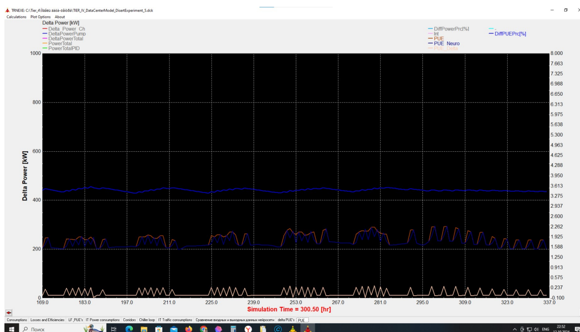
Рис. 9. Разница в PUE между разными видами управления ЦОД
