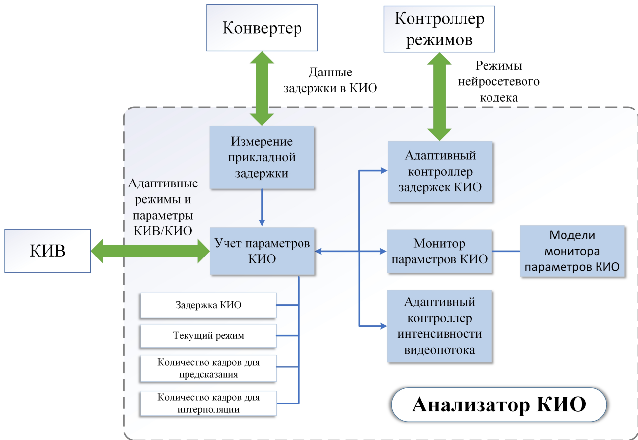
Рис. 5. Структура блока анализатора канала информационного обмена
