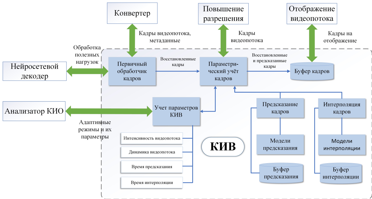
Рис. 2. Структура блока контроля интенсивности видеопотока
