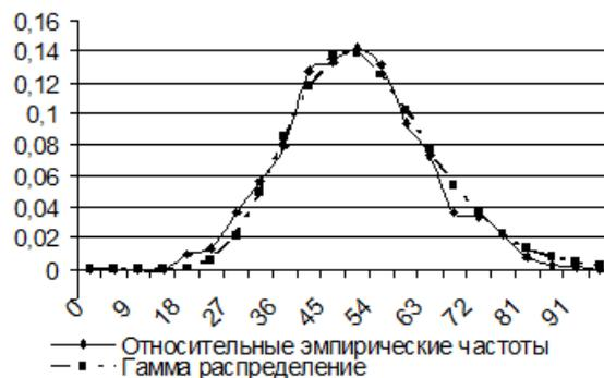
Рис. 20. Эмпирическая плотность распределения скорости передачи данных. Набор и отправление электронного письма 100 пользователей.
