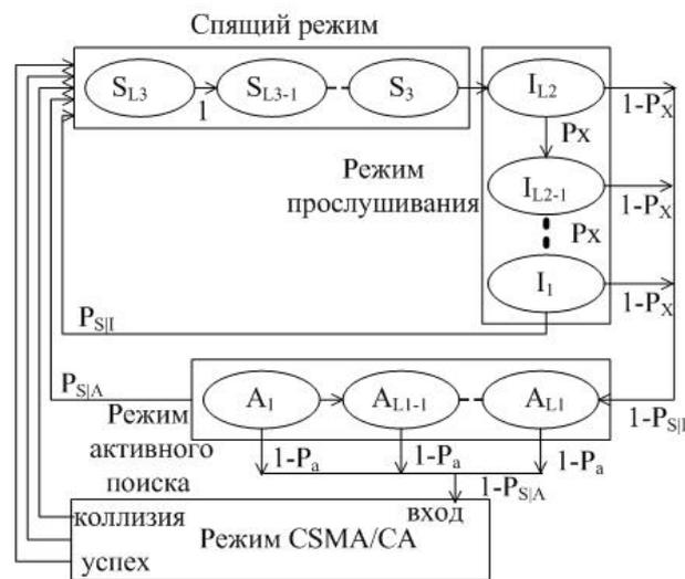
Рис. 2. Функциональная модель узлов ретрансляции
