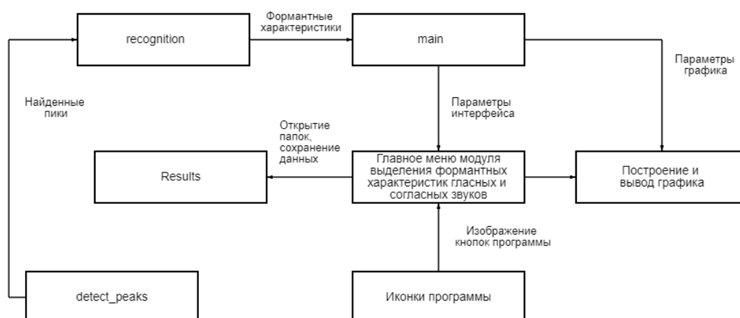
Рис. 4. Структурная схема модуля выделения формантных характеристик гласных и согласных звуков
