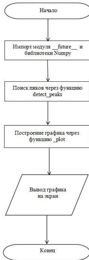
Рис. 7. Блок-схема подмодуля detect_peaks
