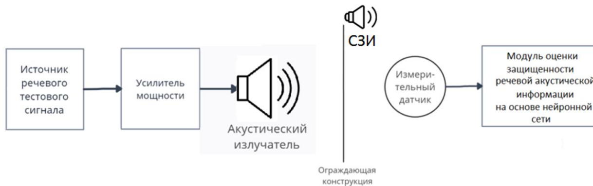
Рис. 2. Схема предлагаемой интеллектуальной системы оценки защищенности речевой акустической информации
